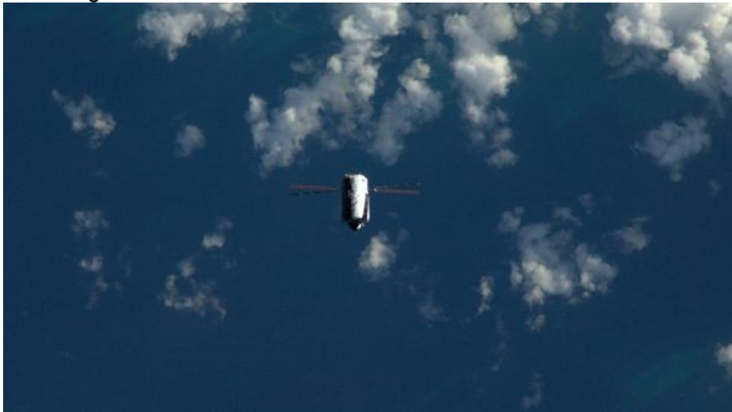
Für das LIRIS-Experiment zur Erprobung einer neuen Technologie für das Andocken flog das ATV-5 (Automated Transfer Vehicle) unterhalb der Internationalen Raumstation ISS.
