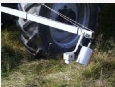
Die zweite Generation des DLR-Wildretters: Die Trägerstange ist mit einem Mikrowellen- und einem Infrarotsensor ausgestattet (Bild: DLR)
