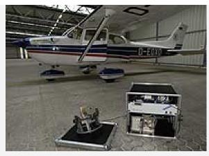
Kamerasystem und Rechnereinheit vor dem Einbau in die Cesna
