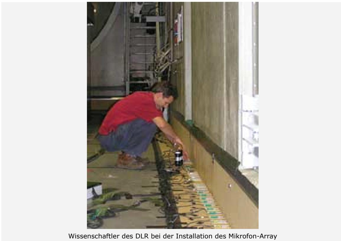
Wissenschaftler des DLR bei der Installation des Mikrofon-Array
