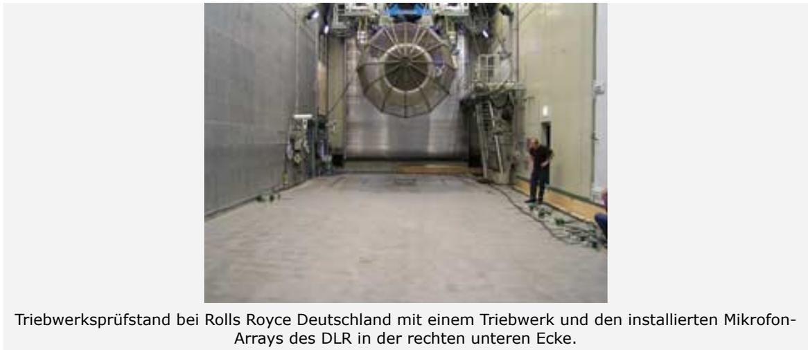
Triebwerksprüfstand bei Rolls Royce Deutschland mit einem Triebwerk und den installierten Mikrofon-Arrays des DLR in der rechten unteren Ecke.
