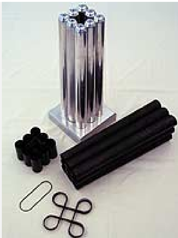
Original-Bauteile des Wabentanks aus Endlosfaserstruktur
