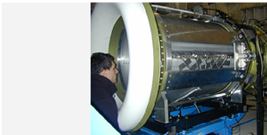
Drehbare Rohrsektion zur Erfassung des Schallfelds im Einlauf des Modelltriebwerks
