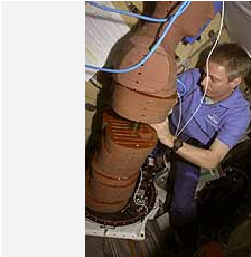
Thomas Reiter beim Ausbau der Detektoren aus MATROSHKA
