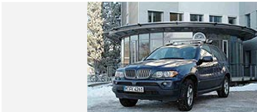
Fahrzeug mit einem Radom für die Satelliten-Empfangsantenne
