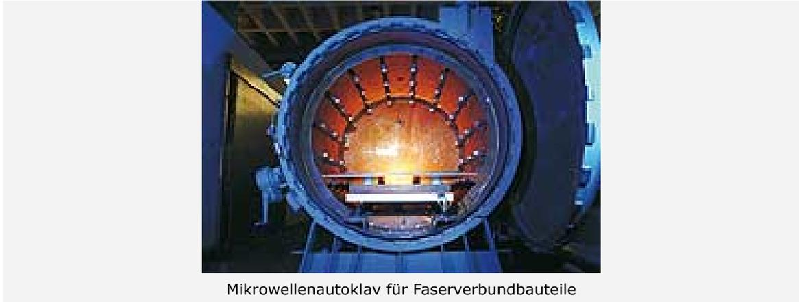
Mikrowellenautoklav für Faserverbundbauteile
