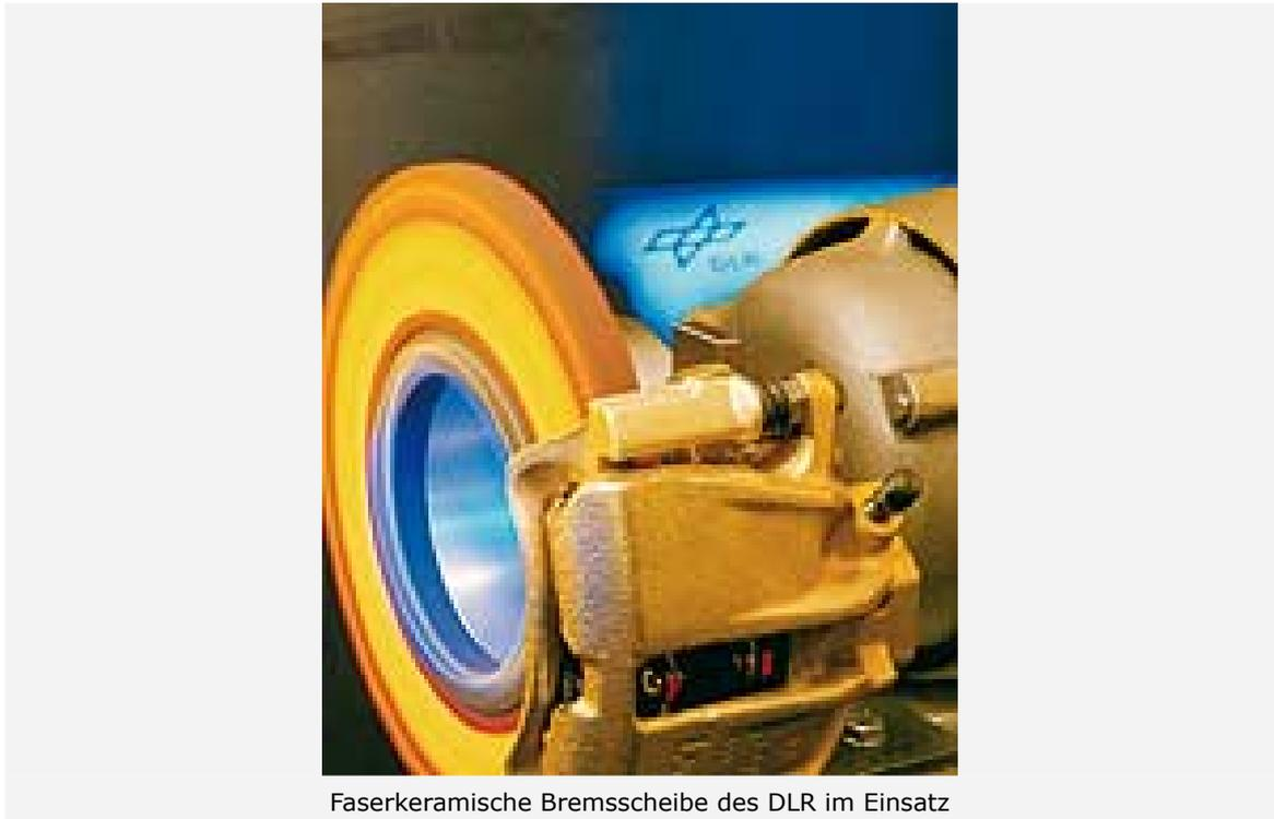
Faserkeramische Bremsscheibe des DLR im Einsatz
