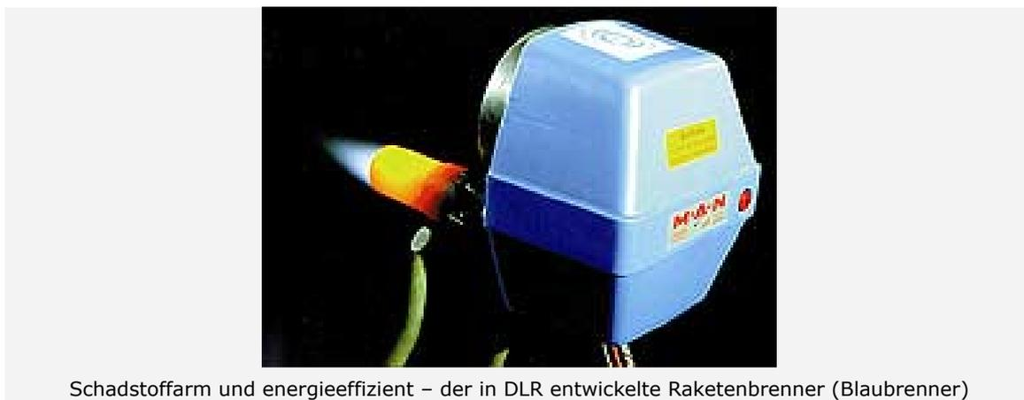
Schadstoffarm und energieeffizient – der in DLR entwickelte Raketenbrenner (Blaubrenner)
