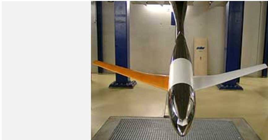
DLR-Modell F4 im Modellvorbereitungsraum des ETW-Windkanals
