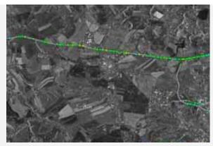
Verkehrsmessung des Radar-Satelliten auf der A4 bei Dresden
