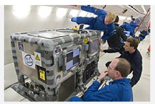
Die PK-4-Anlage während eines Testflugs in Schwerelosigkeit
