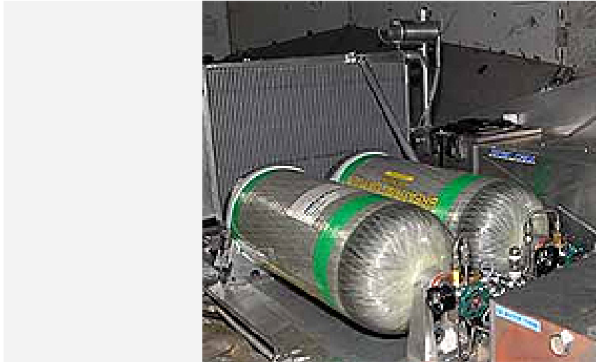
Brennstoffzellen-System im DLR-Forschungsflugzeug ATRA
