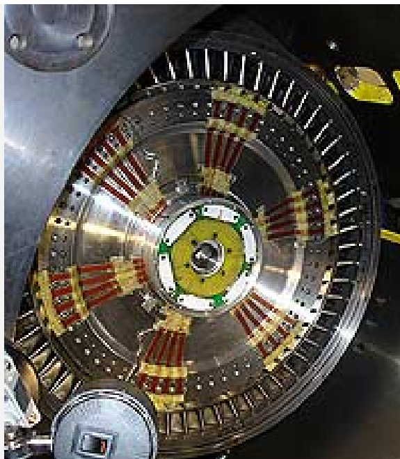
Hochdruckturbinenlaufrad in der Teststrecke
