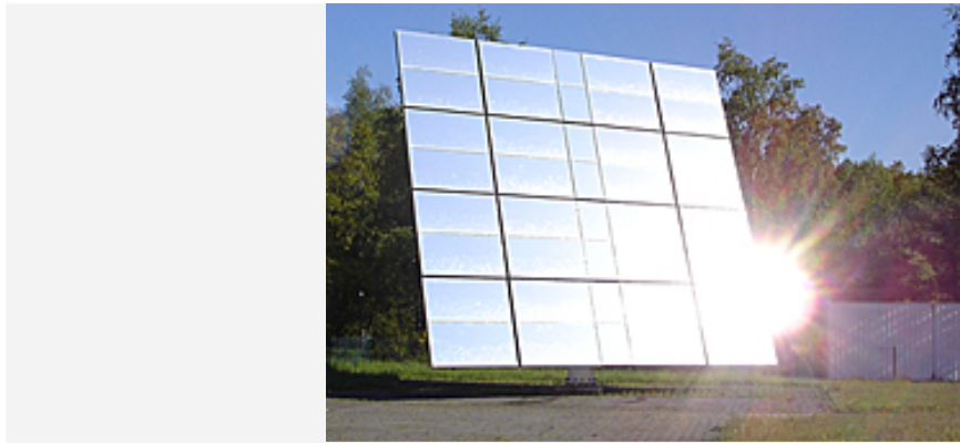
Sonnenofen-Heliostat sammelt auf 57 Quadratmetern die Sonne ein
