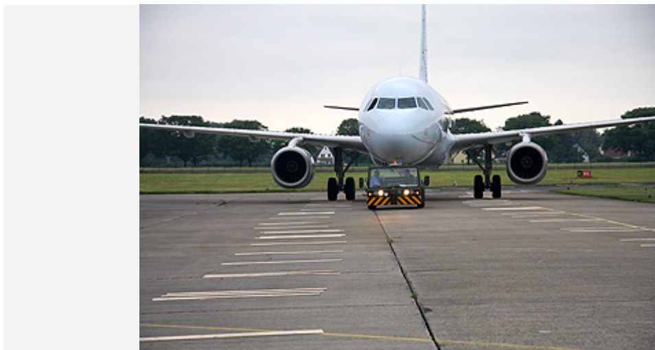
Schwingungsversuch: ATRA holpert über aus Holz präparierte Versuchsstrecke
