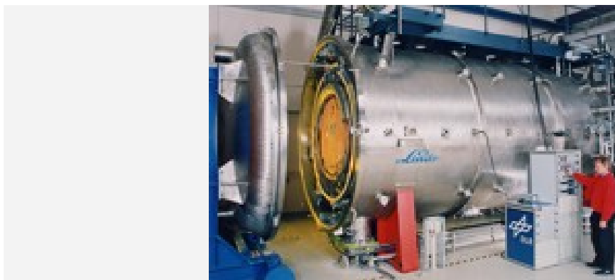
Simulationsanlage für Satelliten-Triebwerke
