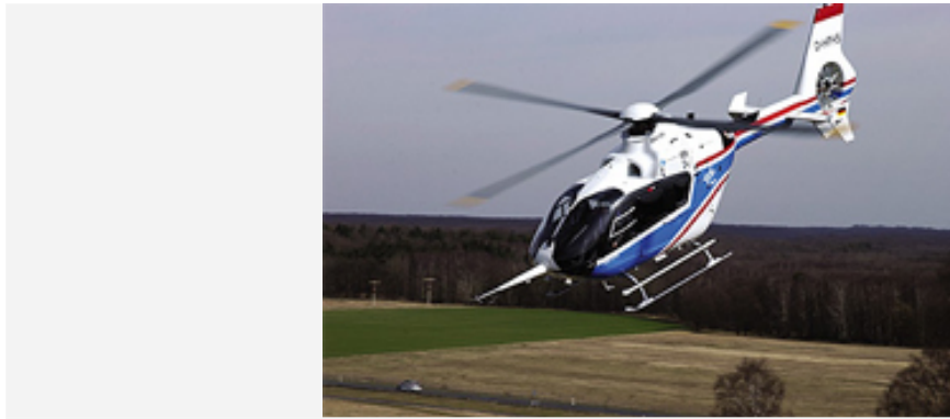
Fliegender Hubschrauber Simulator (ACT/FHS) mit Fly-by-Light- und Fly-by-Wire-Steuerung
