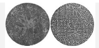
Schnitt durch zwei Aluminium-Silizium-Eisen (AlSiFe) Proben
