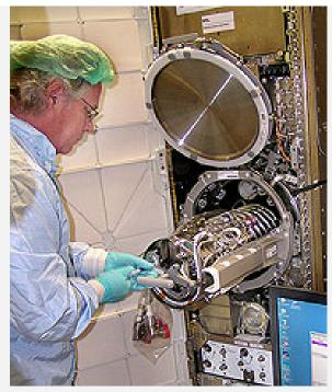
Einsetzen der Experimentkartusche in das MSL während eines Tests beim Hersteller Astrium
