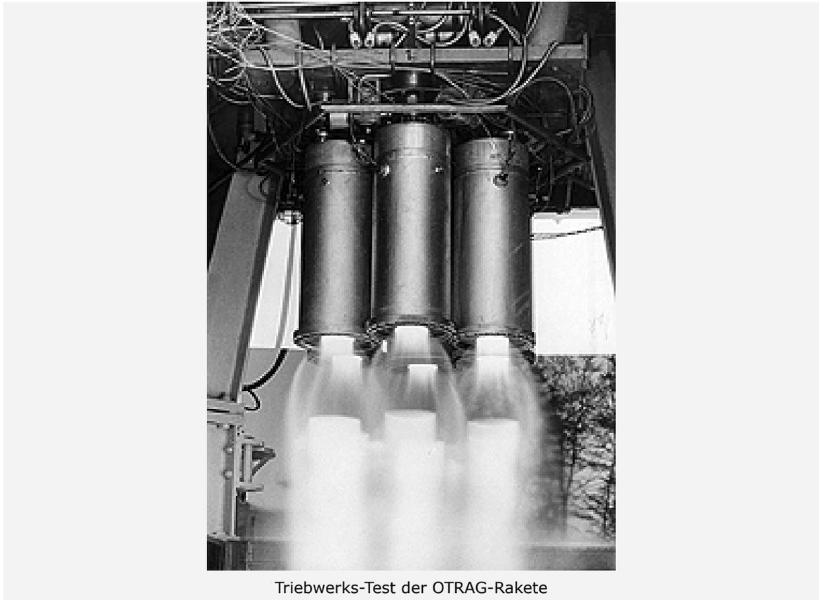
Triebwerks-Test der OTRAG-Rakete
