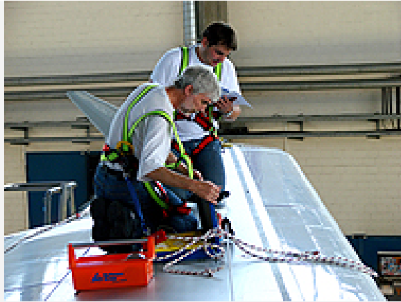
Für die Beschleunigungsmessung wird ATRA mit 140 Sensoren verkabelt
