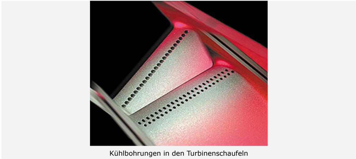
Kühlbohrungen in den Turbinenschaufeln
