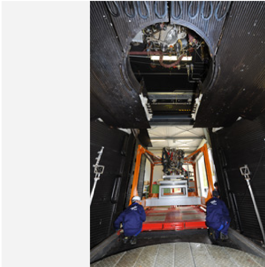
Einbau des Vinci-Triebwerks in die Vakuumkammer des Prüfstandes P4.1
