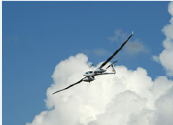
Fliegen mit Brennstoffzellenantrieb: Antares DLR-H2
