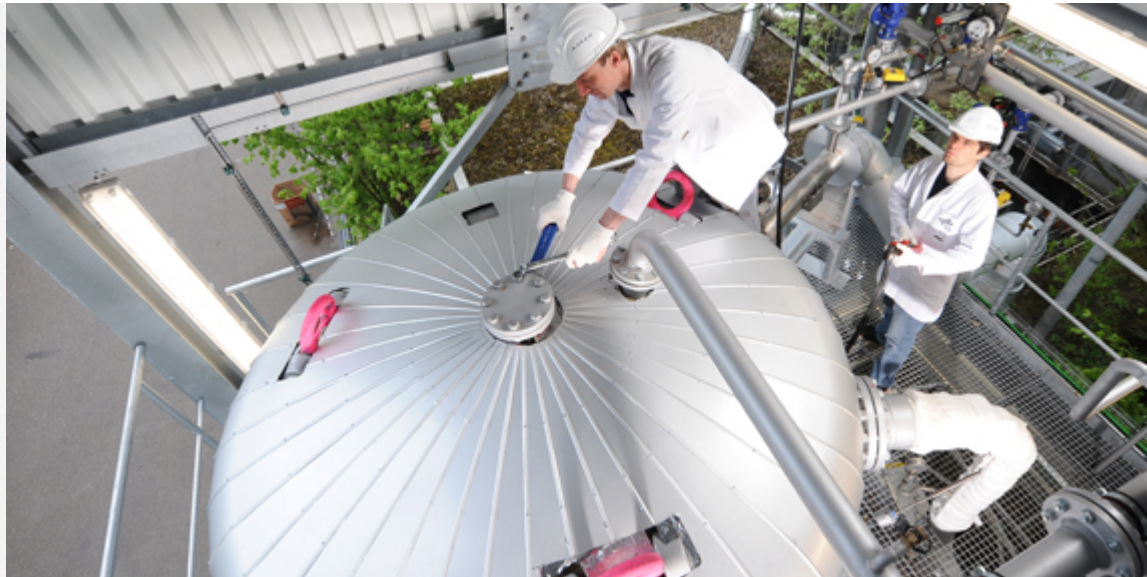
Variabler Speicherteststand mit austauschbarem Innenhälter
