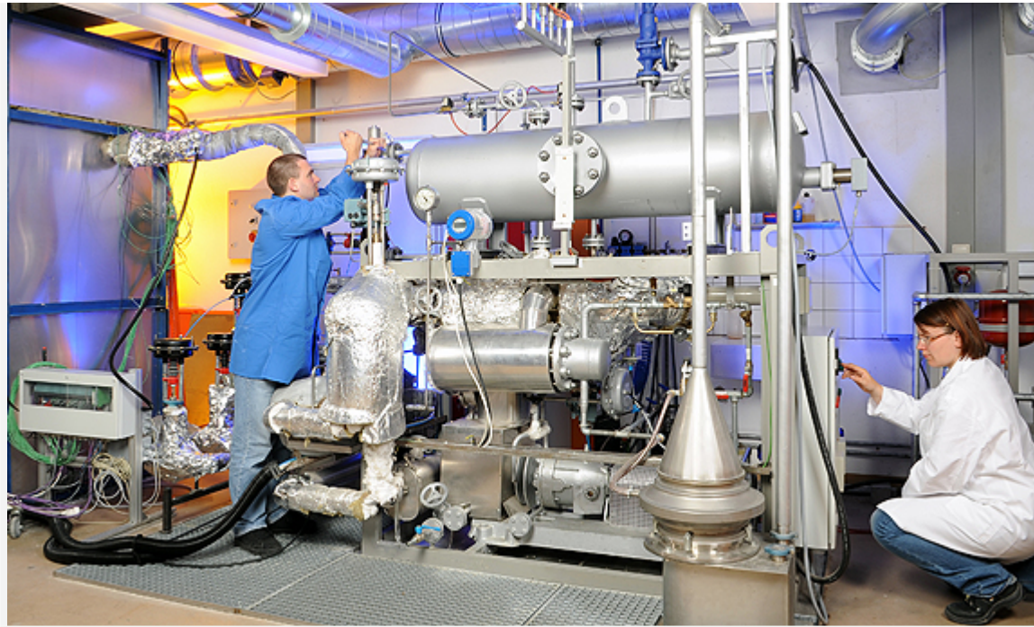
Testanlage für Hochtemperatur-Wärmespeicher
