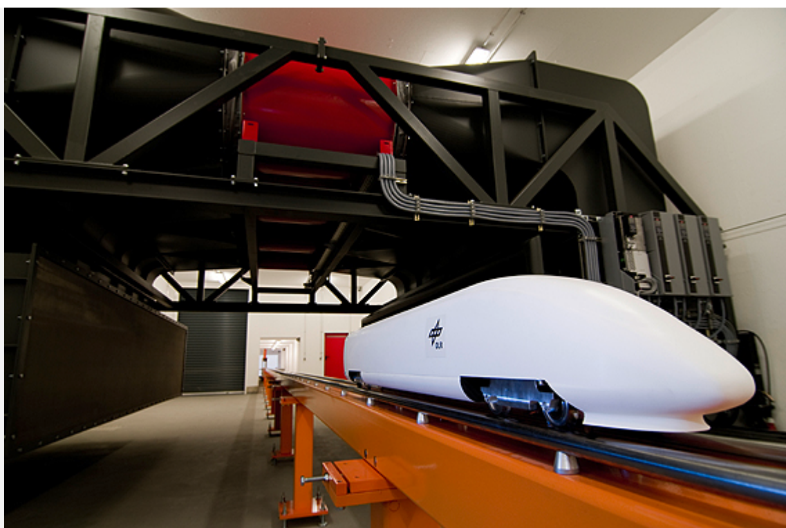
Zugmodell in der Tunnelsimulationsanlage
