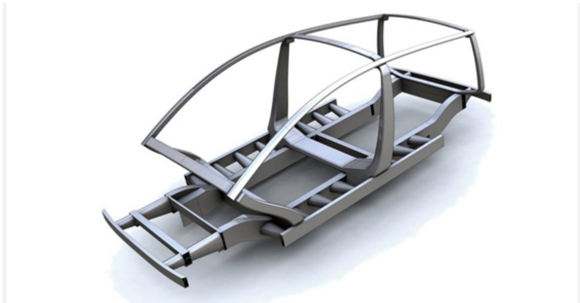
Fahrgastzelle in Spant-Space-Frame-Bauweise
