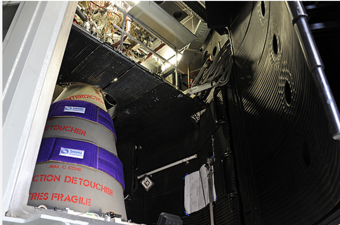
Vinci-Triebwerk mit langer Expansionsdüse in der Vakuumkammer des ESA-Prüfstandes P4.1
