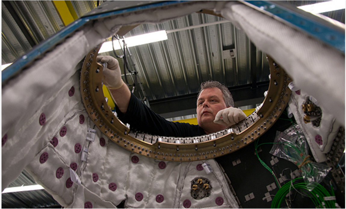
Vorbereitungen am Interface zwischen Thermalschutz-System und Nasenkappe
