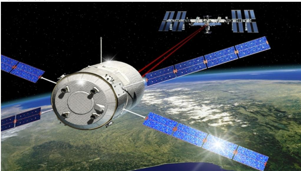
Das ATV-2 dockt mit Hilfe optischer Sensoren vollautomatisch an die Internationale Raumstation ISS an.
