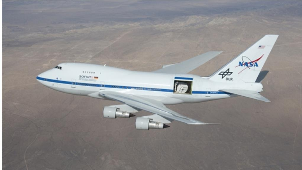
Das Stratosphären-Observatorium für Infrarot-Astronomie SOFIA während seines ersten Testflugs mit vollständig geöffneter Teleskoptür am 18. Dezember 2009 über der kalifornischen Mojave-Wüste. In der Öffnung im Rumpf der Boeing 747SP wird das in Deutschland gebaute 2,7 Meter-Teleskop sichtbar. Der Testflug mit geöffneter Tür ermöglichte den Ingenieuren zum ersten Mal, die Luftbewegungen in und um Teleskop und Tür experimentell zu untersuchen.
