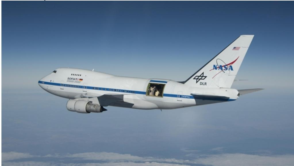
Das Stratosphären-Observatorium für Infrarot-Astronomie SOFIA während eines Testflugs mit geöffneter Teleskoptür am 13. Juli 2010. In der Öffnung im Rumpf der Boeing 747SP ist das in Deutschland gebaute 2,5 Meter-Teleskop sichtbar.
