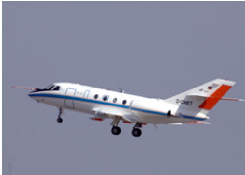
DLR-Forschungsflugzeug Falcon 20-E mit den Anbauten am Flügel, dem Nasenmast für Wind- und Druckmessungen und Lufteinlässen wie sie für die Vulkanaschemessungen eingesetzt wurde.
