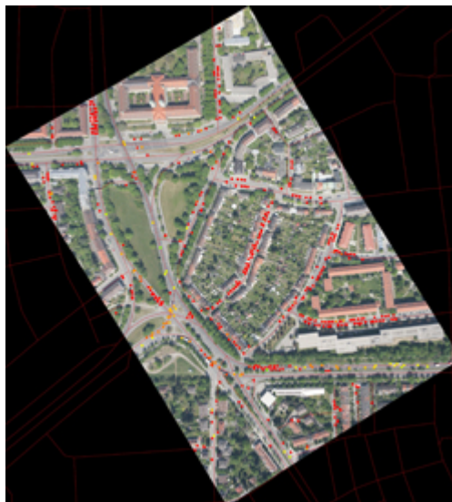
Aufnahme einer Straßenkreuzung in München mit dem DLR 3K Kamerasystem aus 1000 Meter über Grund. Die farbigen Punkte stellen automatisch detektierte Fahrzeuge mit deren Geschwindigkeiten dar.
