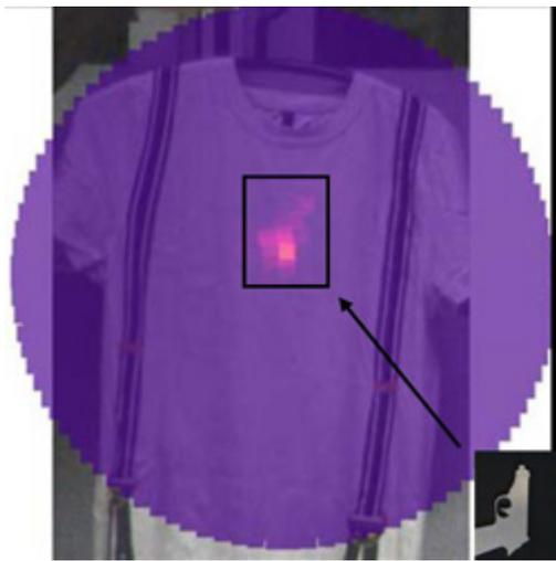
Terahertz-Bild (farbig) einer von einem T-Shirt verdeckten Waffentrappe. Das Terahertz-Bild wurde dem visuellen Bild der gleichen Szene überlagert (schwarz-weiss). Die Waffentrappe war 18 m vom THz-Scanner entfernt.
