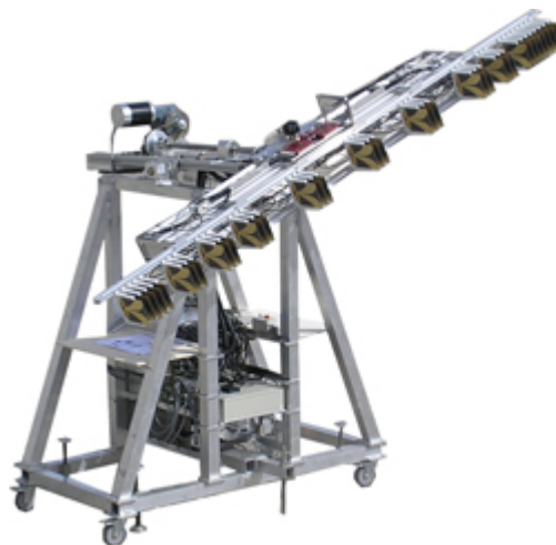
ANSAS-System mit multi-spektraler zweidimensionaler Abbildungsfähigkeit durch kombiniertes elektronisches und mechanisches Abtasten.
