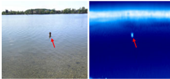
Ein Schwimmer, von dem nur der Kopf aus dem Wasser ragt, ist klar detektierbar (rote Pfeile). Bild: DLR.
