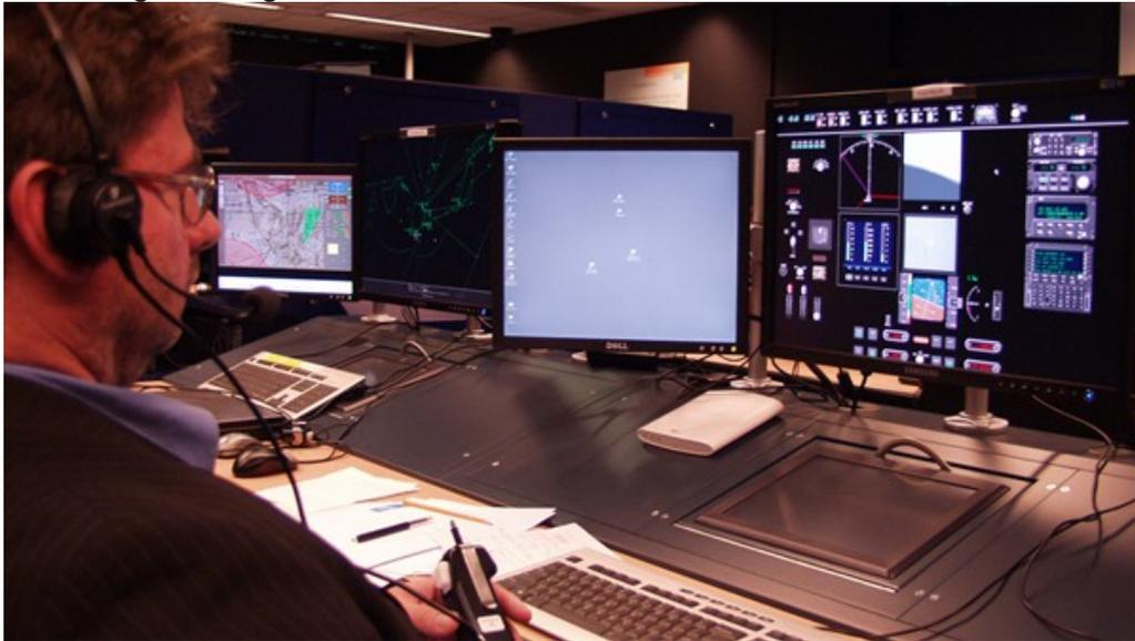
Ein Pilot steuert den Flug eines UAS vor einer Bodenkontrollstation während der ESA-Studie "Satellites for the Integration in Nonsegregated Airspace of UAS in Europe".
