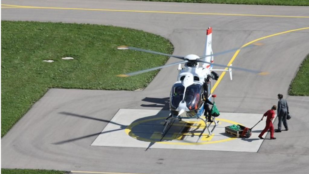
Der DLR-Forschungshubschrauber FHS (Fliegender Hubschrauber-Simulator) bei der Vorbereitung für die Testflüge mit der Außenwinde.
