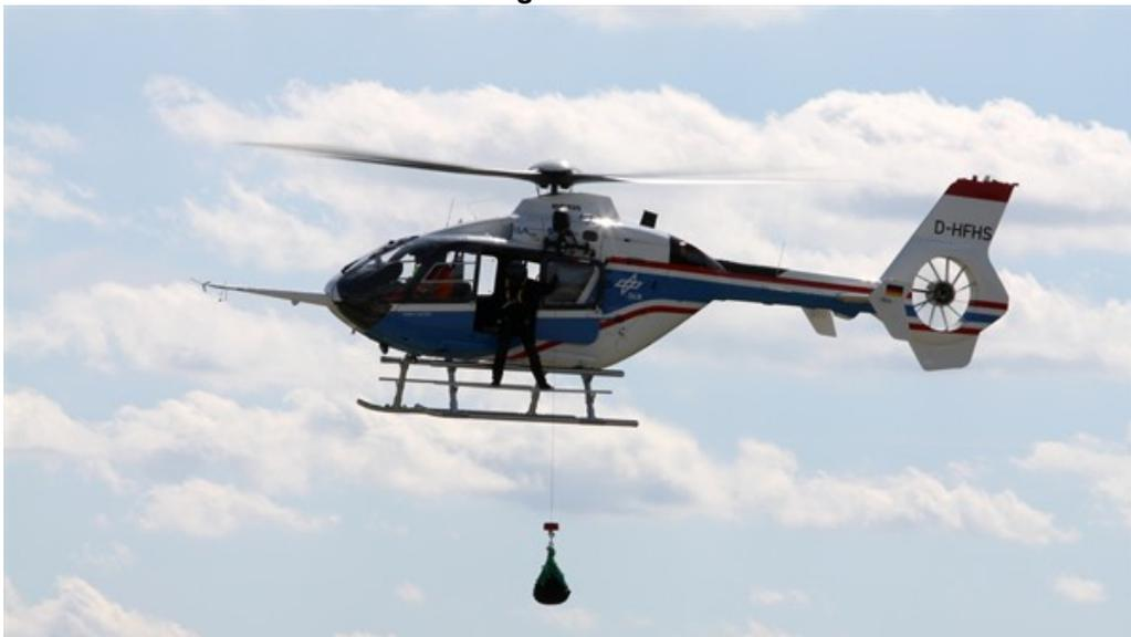
Bei den Flugversuchen wurde die an den FHS angebaute Rettungswinde überprüft.
