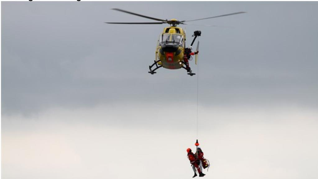
Das richtige Bedienen der Außenwinde muss geübt sein. Bei den späteren Flugversuchen mit dem Pilotenassistenzsystem des Projekts HALAS übernimmt der Flugversuchingenieur das Bedienen der Winde.
