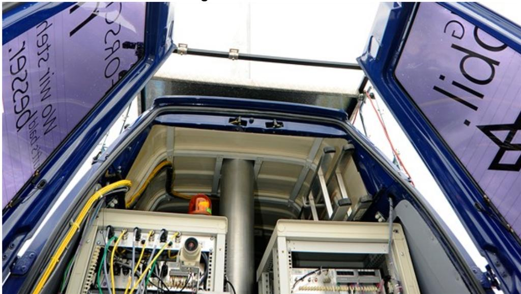
Vabene kann auch mobil zum Einsatz kommen: Die Daten werden dann in einem DLR-Forschungsfahrzeug mit einem ausfahrbaren Mast den für Mikrowellenlink empfangen. Die Server-Infrastruktur kann dann in einem Zelt aufgebaut werden.
