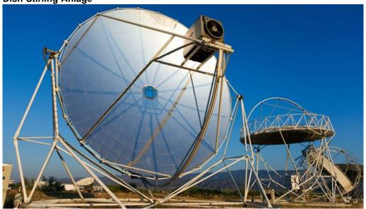
In Dish-Stirling-Anlagen wird die Sonnenstrahlung durch einen schüsselförmigen Spiegel auf einen Punkt konzentriert. Die dort konzentrierte Wärmeenergie wird mit einem Stirlingmotor in mechanische Energie umgewandelt. Damit wird in der Regel in einem direkt angekoppelten Generator elektrische Energie erzeugt.
