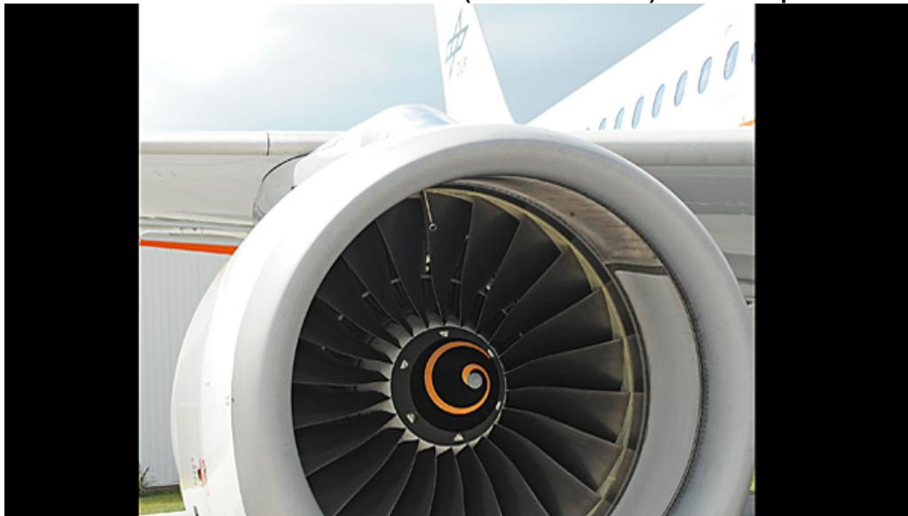
Für die Lärmreduktion in Flugzeugtriebwerken haben sich bisher Schalldämpfer in Form von perforierten Wänden mit dahinterliegenden kleinen Hohlräumen, auch Liner genannt, als effizient erwiesen. Sie leisten aktuell den größten Beitrag zur Minderung des abgestrahlten Triebwerksschalls besonders bei lästigen hohen Tönen.
