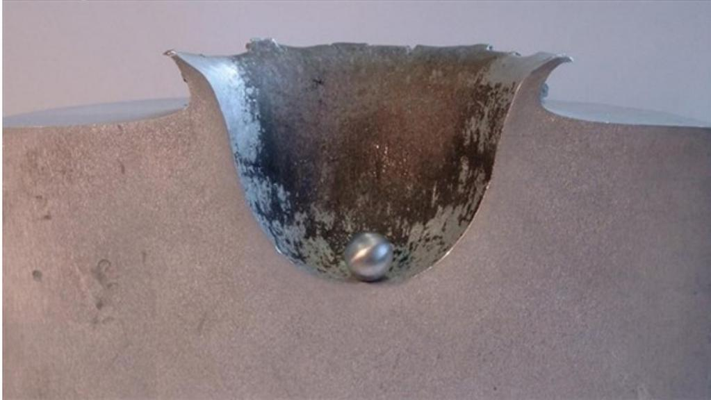
In einem Labor-Experiment der Europäischen Weltraumorganisation ESA wurde eine kleine Aluminiumkugel mit etwa 6,8 Kilometern in der Sekunde auf einen 18 Zentimeter starken Aluminiumblock geschossen. Dabei wird deutlich erkennbar, welche Schäden dabei entstehen. Ähnliche Auswirkungen hat eine Kollision von Weltraumschrott mit einem aktiven Satelliten im All.
