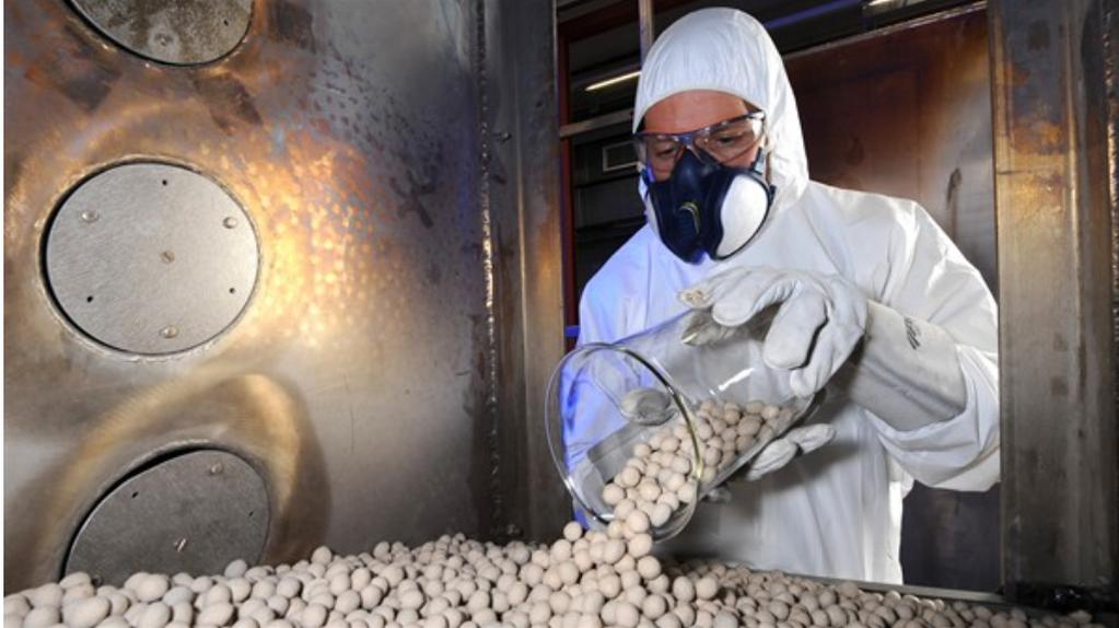
DLR-Forscher am Institut für Technische Thermodynamik testen Keramik-Materialien (hier im Bild), Flüssigsalze, Beton und Natursteine als Wärmespeicher.
