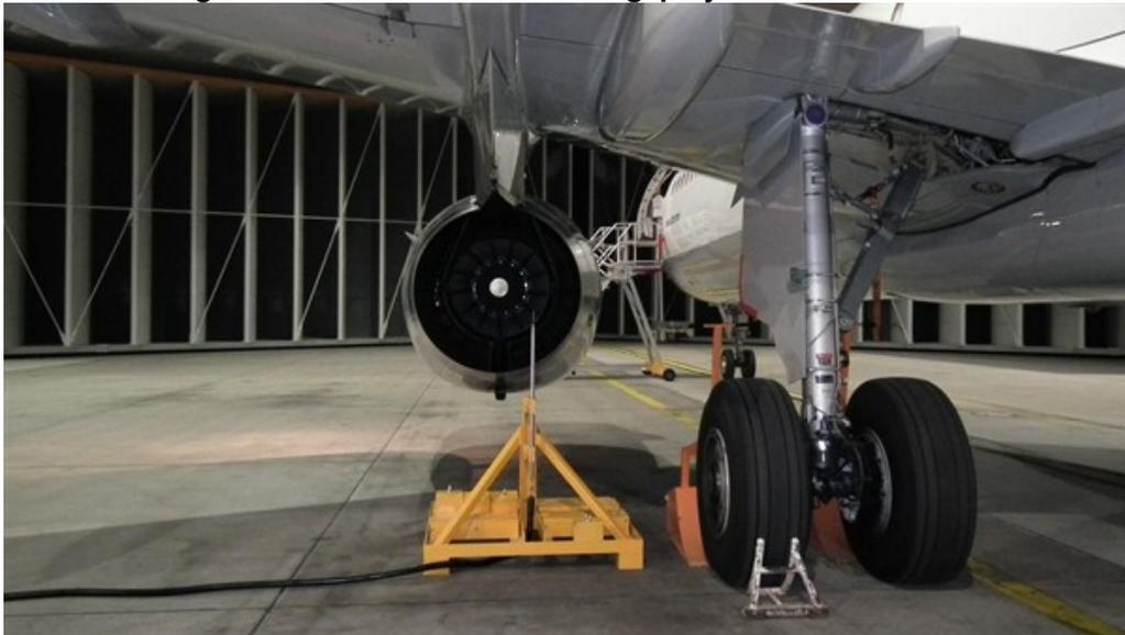
Die Tests mit Biokerosin fanden während der Nacht am Lufthansa-Flugplatz Fuhlsbüttel statt, dabei wurden am Boden die Phasen eines Fluges, wie zum Beispiel Start, Steigflug oder Landeanflug, simuliert. Die Forscher führten die Sondenmessungen an beiden Triebwerken durch und konnten so den Schadstoffausstoß zwischen der 50 prozentigen Bio-Kerosin-Mischung und dem marktüblichen Kerosin vergleichen.
