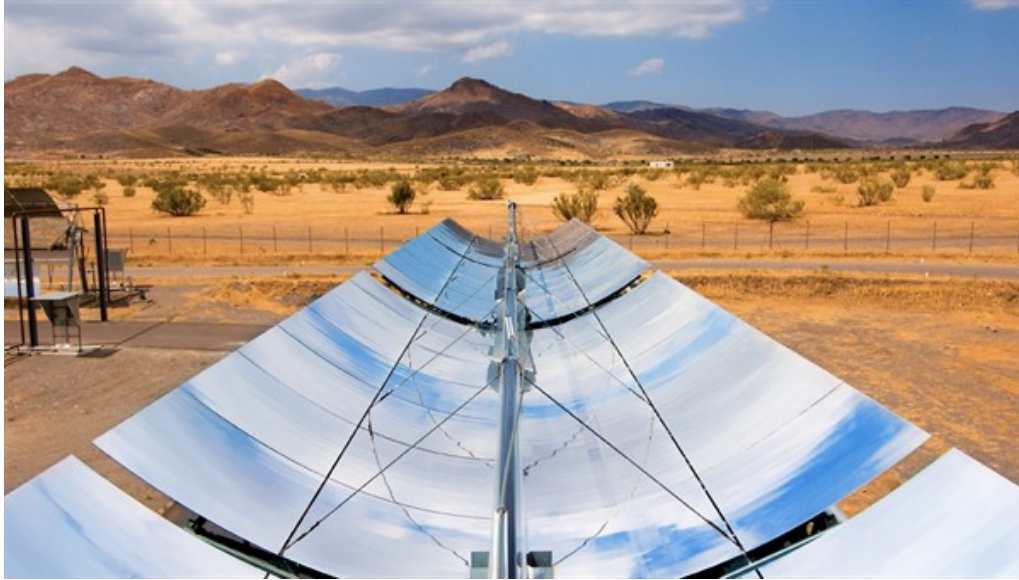
Parabolrinnenanlage auf der Plataforma Solar de Almería
