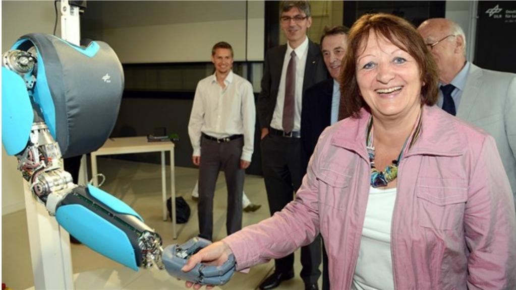
Das Leichtbau-System „HASy“ - ist "passiv nachgiebig" und kann dadurch, ähnlich wie der Mensch, plötzliche Stöße abfangen. Das beugt Materialschäden vor. Der Clou liegt in einem mechanischen Element, das mit Hilfe eines komplexen Antriebs vorgespannt wird - etwa wie ein Muskel. Bei Druck gibt das Gelenk einfach nach.
