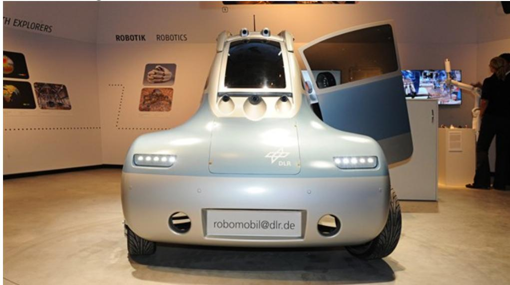
Gleich 18 Kameras sehen für das Robomobil in alle Richtungen. Damit kann das Fahrzeug im Straßenverkehr beispielsweise Fußgänger und Fahrradfahrer erkennen und ihnen ausweichen.
