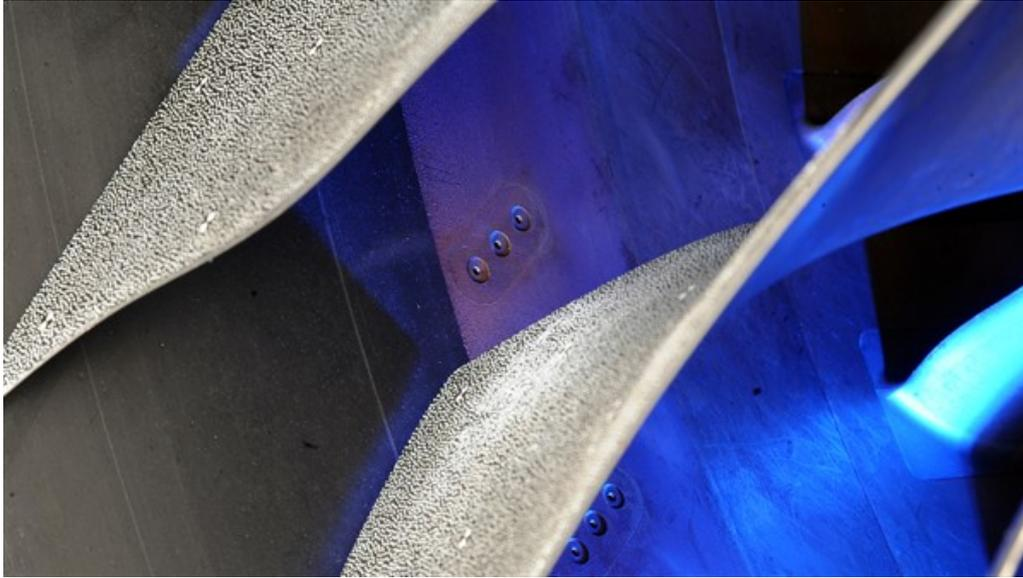
Die Akustiker des DLR-Instituts für Antriebstechnik entwickelten deshalb in den letzten Jahren ein neuartiges aktives Verfahren zur Minderung von Triebwerkstönen. Es basiert auf dem gezielten Einblasen von Druckluft direkt hinter dem Hauptrotor des Triebwerks, dem so genannten Fan.
