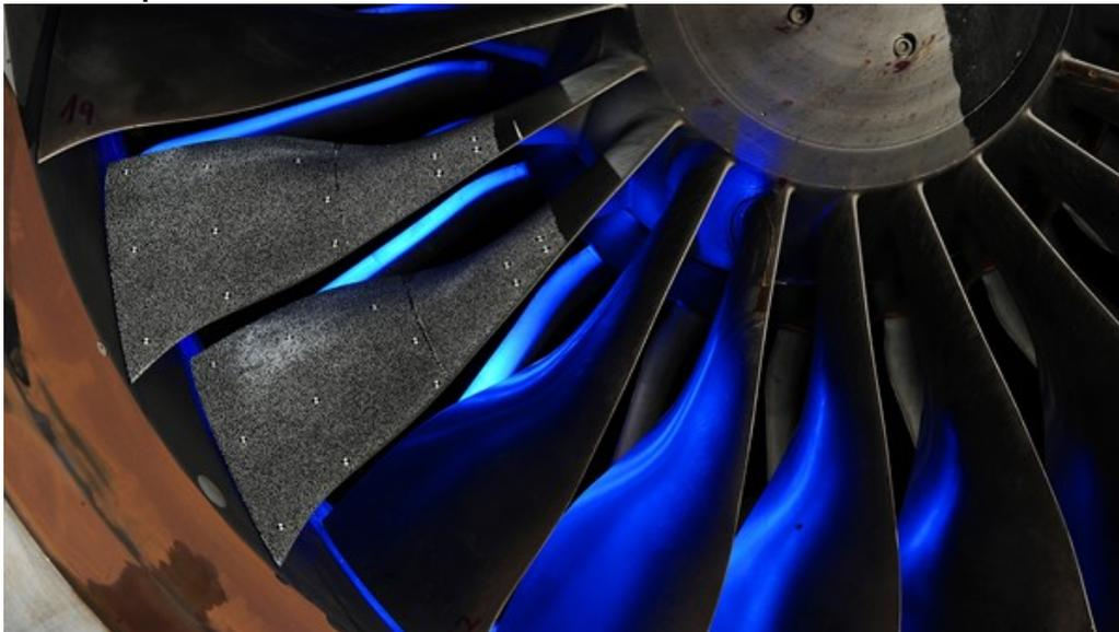
Parallel zu den akustischen Demonstrationsversuchen wurden umfangreiche Detailmessungen zur Strömung im Triebwerksfan und dem Schwingungsverhalten der Fanschaufeln durchgeführt.
