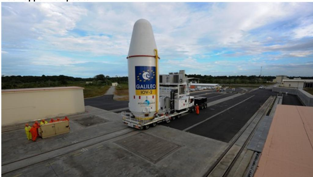
Das so genannte "Upper Composite", bestehend aus der vierten Stufe (Fregat-MT) sowie den beiden Galileo-Satelliten.
