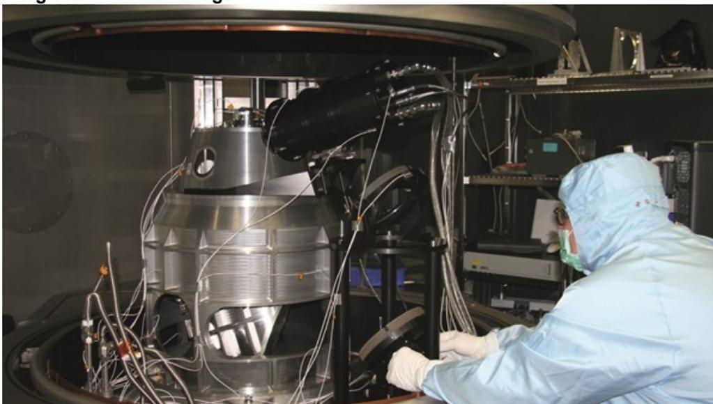
Entwicklungsstudie für das Erdbeobachtungsinstrument METimage in den Integrations- und Testräumen der Jena-Optronik GmbH. Das Foto zeigt die Integration in die Thermalvakuumkamera.
