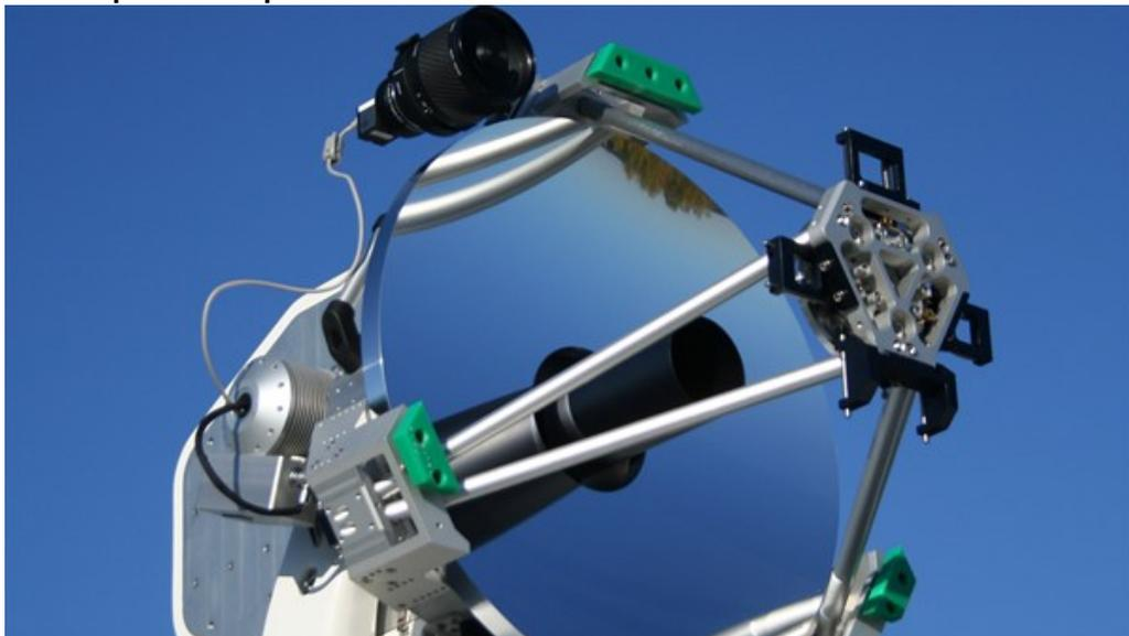
Das Herzstück der transportablen Bodenstation TOGS ist ein Teleskop zum Datenempfang. Es hat einen Durchmesser von 60 Zentimetern und ist für Verbindungen mit Flugzeugen und Satelliten optimiert.
