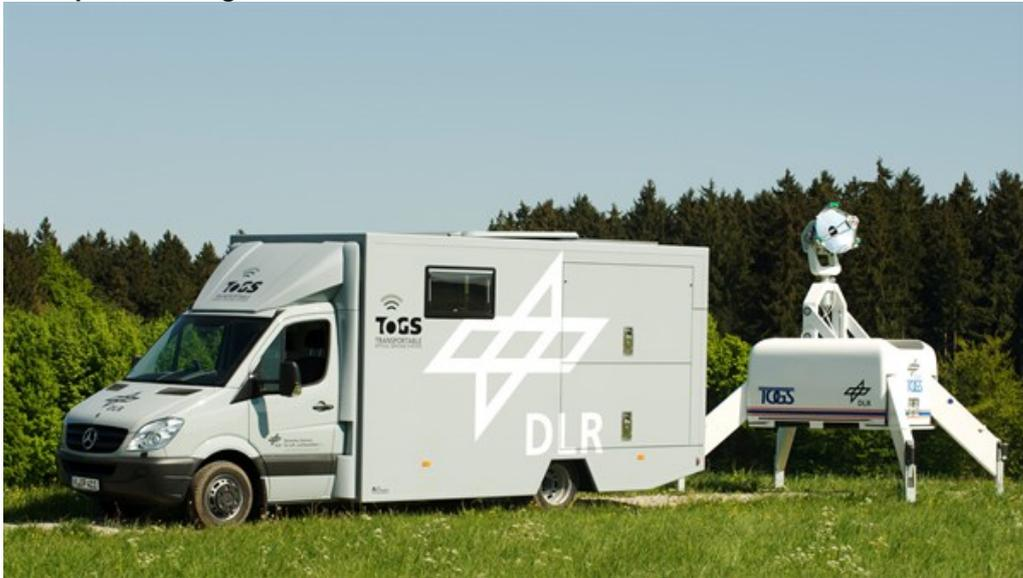
Die transportable optische Bodenstation TOGS neben dem Transportfahrzeug. Am Einsatzort angekommen, wird das Teleskop automatisch ausgefaltet. In nur zehn Minuten kann der Einsatz beginnen.
