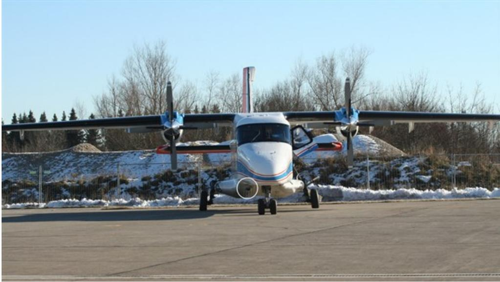
Das DLR-Forschungsflugzeug Do228-212 beim Testbetrieb des Experimentaleinbaus zur optischen Kommunikation. Der Außenanbau des Laserterminals befindet sich links unter dem Rumpf.
